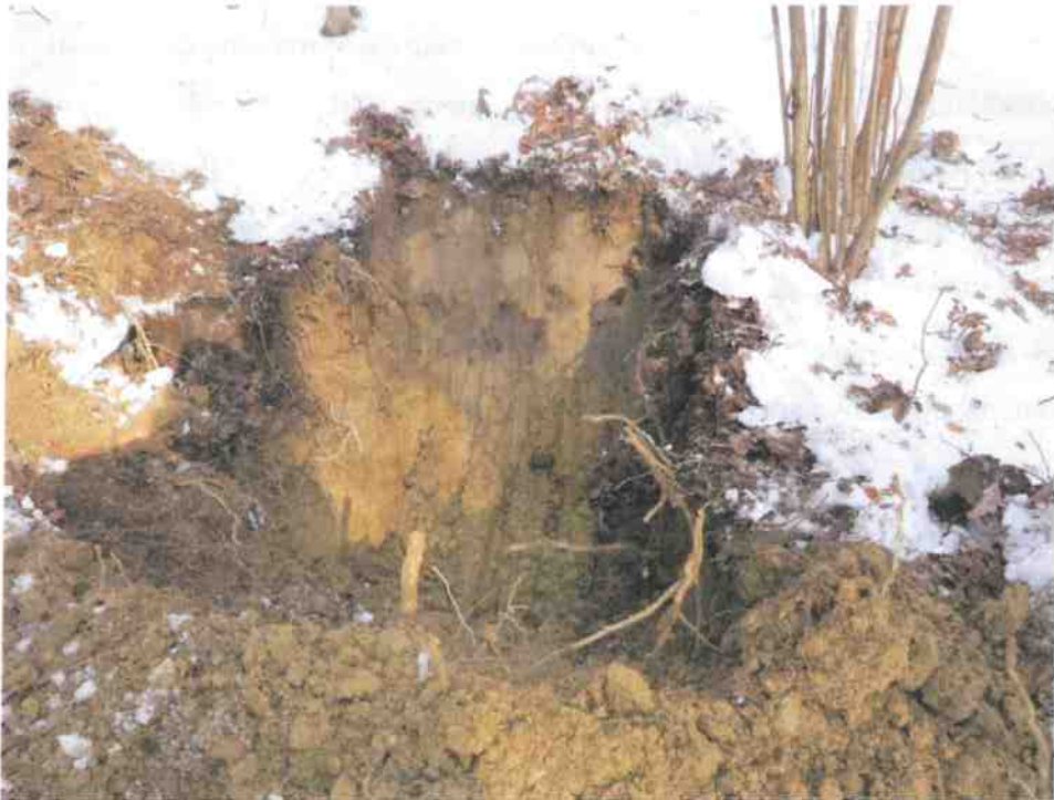
Obr. č.4. Ílovito- hlinité podložie je vhodný zdroj pre ílové tesnenie.
